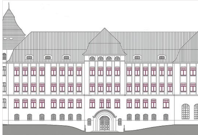
Planzeichnung der Ostseite der ehemaligen Weinbergsschule als Teil des Gebäudeensembles des Gymnasiums Franziskaneum: Die vergebenen Tischlerarbeiten betreffen die rot markierten Fenster.
